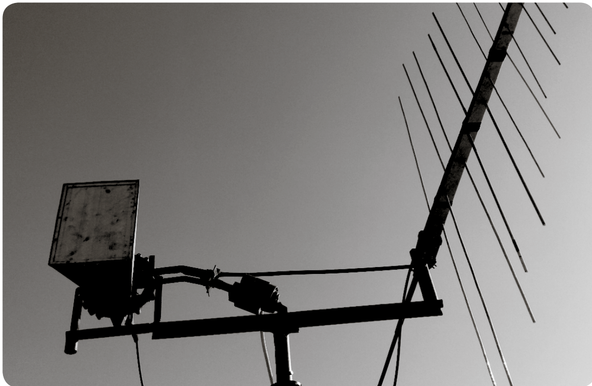
Рупор ва логопериодик антенна қурилмалари қутбланишни ўзгартирадиган Д-38Т двигатели билан.
